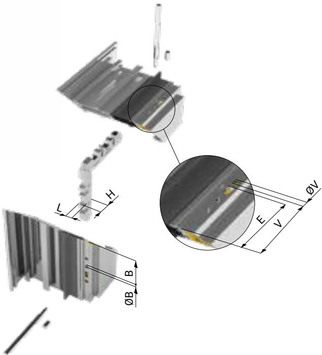
Squadra di giunzione angolare in alluminio pressofuso multifunzione a spinare o cianfrinare o avvitare. Impiegata normalmente nella seconda tubolarità dei profili TT, ha funzioni di serraggio e supporto alla squadretta principale. Le spine e le viti sono vendute separatamente.
