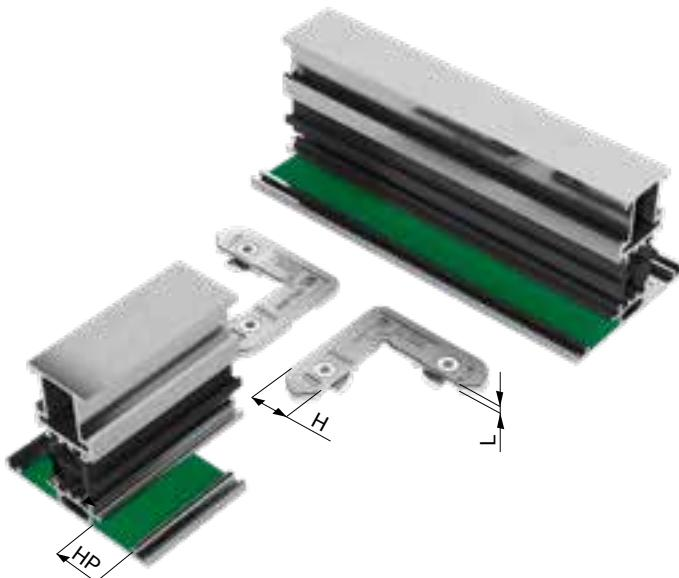
Squadra o cavallotto di allineamento in alluminio pressofuso con funzione di serraggio per giunzioni angolari, a T e a croce. Tramite due eccentrici regolabili, è l'unica squadretta che riesce veramente a chiudere ed allineare le alette dei profili in maniera impeccabile. Può essere inserita a serramento montato. Il profilo non necessita di lavorazioni.
