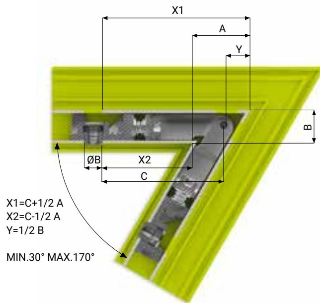
Squadra di giunzione ad angolazione variabile con blocchetti di fissaggio a scatto reversibili (ancoraggio interno o esterno) in alluminio pressofuso, e snodo in acciaio. Squadra di facile applicabilità, di massima robustezza e finitura.
