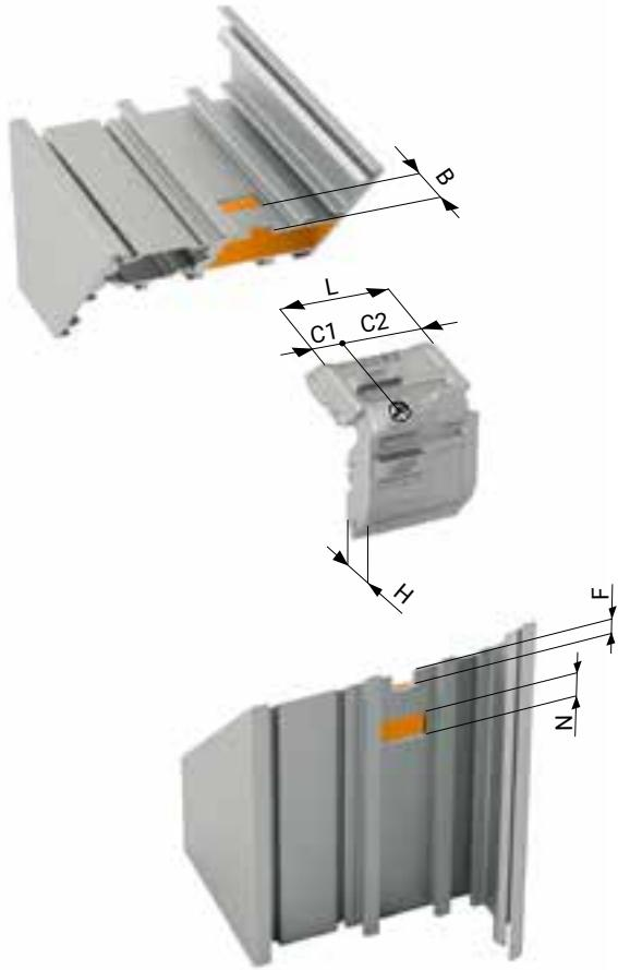
Squadra di giunzione angolare in alluminio pressofuso con serraggio mediante grano al vertice e ancoraggi fissi esterni. Questa squadretta ad espansione verticale con grano al vertice sostituisce le classiche in estruso perfezionando l'assemblaggio dei profili. Dispone di piste specifiche per passaggio colla che consentono una perfetta sigillatura e conferiscono maggiore resistenza alla giunzione evitando inutili sprechi di collante. **Brevettata.**
