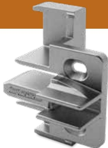
Staffa in alluminio pressofuso per l'installazione di facciate continue con montaggio frontale. Questo sistema elimina la necessità di scantonare i traversi, consentendo un significativo risparmio di tempo e di materiale. La parte frontale della staffa riproduce esattamente la sagoma del profilo, permettendo di mantenere la continuità estetica e di svolgere anche la funzione di convogliatore per la condensa. Ancoraggio ad incastro e serraggio tramite viti autofilettanti.
