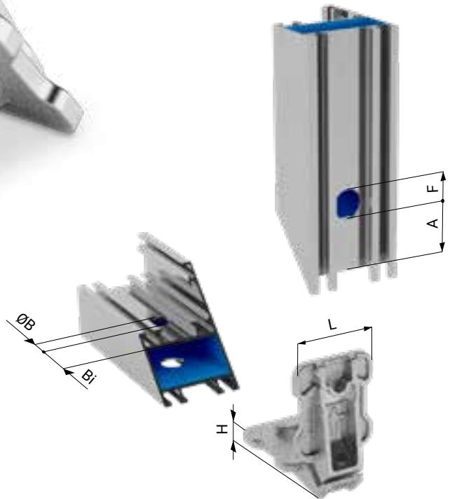
Squadra di giunzione angolare in alluminio pressofuso, con pulsanti di ancoraggio fissi rivolti all'interno e vite di serraggio su corpo squadra filettata. Inserimento agevolato con ancoraggio automatico dei pulsanti. Utilizzabile anche su profili aperti (sagoma a forma "U"). **Attrezzatura di serraggio richiesta: chiave esagonale. Brevettata.**
