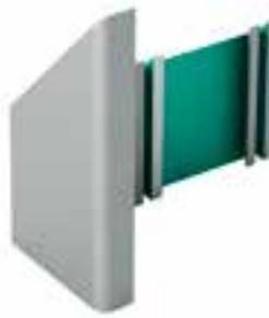
Squadra di giunzione e allineamento in alluminio pressofuso con viti di serraggio esterne, per profili aperti. Telai di porte sono gli esempi di utilizzo principali. Il profilo non necessita di lavorazioni. Dispone di piste specifiche per passaggio colla per consentire una perfetta sigillatura e conferire maggiore resistenza alla giunzione evitando inutili sprechi di collante.
