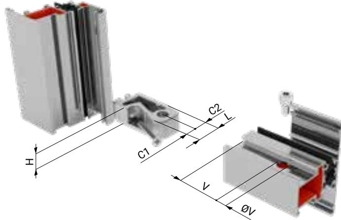
Cavallotto in alluminio pressofuso a infilare, per giunzioni a T e a croce. Con vite autofilettante di fissaggio sul montante e vite o spina di serraggio sul traverso. Cavallotto molto robusto, progettato per non permettere al traverso di ruotare; il sistema di fissaggio su traverso non deforma assolutamente il profilo. Dispone di passaggi colla dedicati per sigillare perfettamente il tubolare. Un'indicazione posta al centro del cavallotto ne facilita il posizionamento.
