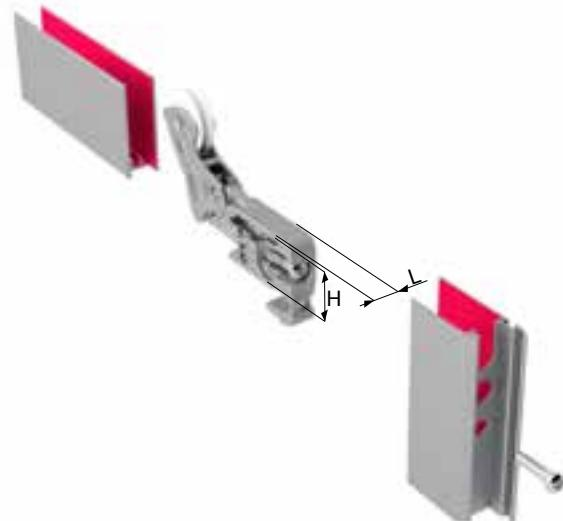
Giunzione angolare per assemblaggio di zanzariere, ante e scorrevoli realizzati con profili a 90°. Premontaggio ad incastro, fissaggio e regolazione mediante viti con impronta Recex®. Vendibile singolarmente o assemblata all'esclusivo carrellino con cuscinetto a sfere rivestito in poliossimetilene (POM). **Trattamento anticorrosione Montix su richiesta.**
