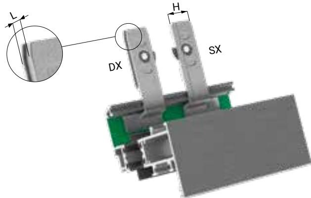
Cavallotto di allineamento ad aggancio rapido in alluminio pressofuso con eccentrico di serraggio per giunzioni a T e a croce con profili a taglio termico. Il profilo non necessita di lavorazioni. Inserimento ad angolo già montato.
