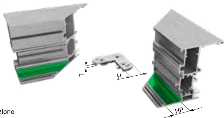
Squadra di allineamento in alluminio pressofuso con funzione di serraggio. Tramite due eccentrici regolabili, è l'unica squadretta che riesce veramente a chiudere ed allineare le alette dei profili in maniera impeccabile. Può essere inserita a serramento montato. Il profilo non necessita di lavorazioni. **Protetta da trattamento anticorrosione Montix.**
