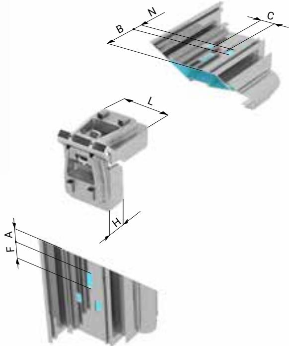
Squadra di giunzione angolare in alluminio pressofuso, con doppi pulsanti di ancoraggio a scatto rivolti all'esterno e vite di serraggio. **Attrezzatura di serraggio richiesta: chiave esagonale.**
