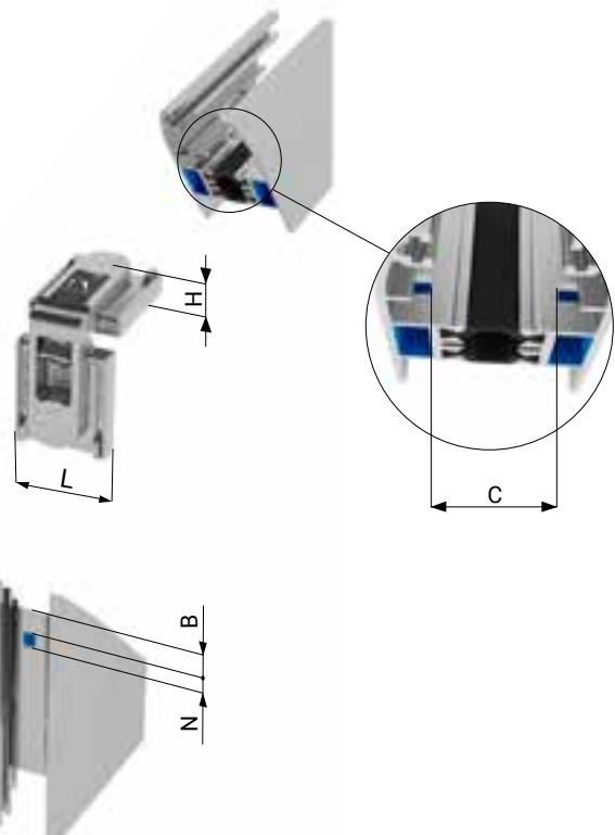
Squadra di giunzione angolare in alluminio pressofuso con doppio ancoraggio fisso interno. Vite e dado di serraggio. Ideale per profili scorrevoli TT. Dotata di isolamento in PVC, si aggancia sulle estremità del profilo in alluminio consentendo una perfetta chiusura garantita nel tempo. **Attrezzatura di serraggio richiesta: chiave esagonale.**
